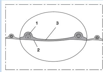
Abriebfester Absaug- und Gebläseschlauch; superleicht und verstärkt, hochflexibel + stauchbar 3:1
