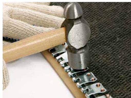
**6** Dar vuelta la banda, colocándola sobre una superficie lisa y sólida. Cortar los remaches con Alicete Ferrart y remacharlos con un martillo liviano, procurando que no sobresalga el remachado sobre la superficie de las grampas.
