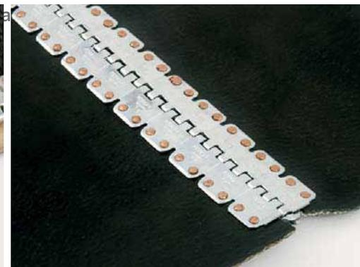
**8** Juntar las puntas de la banda en los espacios correctamente e insertar el pasador. Colocar por último los retenes del pasador. Hacer una muesca unicamente en el borde de salida de la banda. El empalme esta listo.
