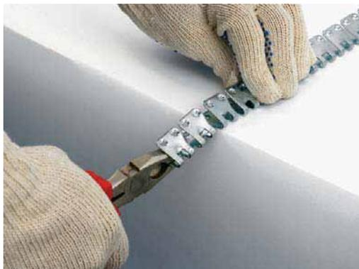
**2** Cortar la tira de grampa una pulgada mas corta que el ancho de correa donde se encuentra la marca de corte, como muestra la figura.
